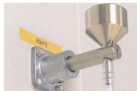
In jedem Raum und an jeder Werkbank sind Partikelsammler angebracht. Particle counters are installed in every room and at every work bench.
