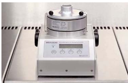
Keimsammler. Bei mehreren Chargenwechsel täglich muss nach jedem validierten Reinigungsvorgang Keimfreiheit sichergestellt sein. Germ collector. With several batch changes every day, freedom from germs must be guaranteed after each validated cleaning process.
