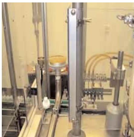
In der linken Bildhälfte sind Partikelzähler und Messkopf für die Keimzählung erkennbar. The particle counter and measuring head for germ counting can be seen on the left hand side of the picture.
