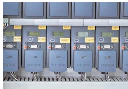
Datenlogger Opus300i mit Anzeigenfeld für Partikelzahl. Opus300i datalogger with display field for particle count.
