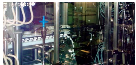
Partikelmessung direkt an der Abfüllung in laminarer Strömung. Particle measurement in the laminar flow right at the point of filling
