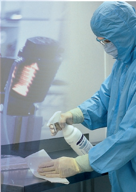
Abb. 2: Ein geschlossenes Sprühflaschensystem verhindert das Eindringen von Luft und die Möglichkeit einer Kontamination der Flüssigkeit.
