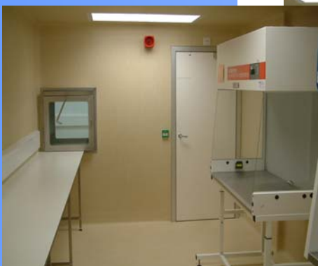
Reinraum mit Laminar-Flow-Kabine
